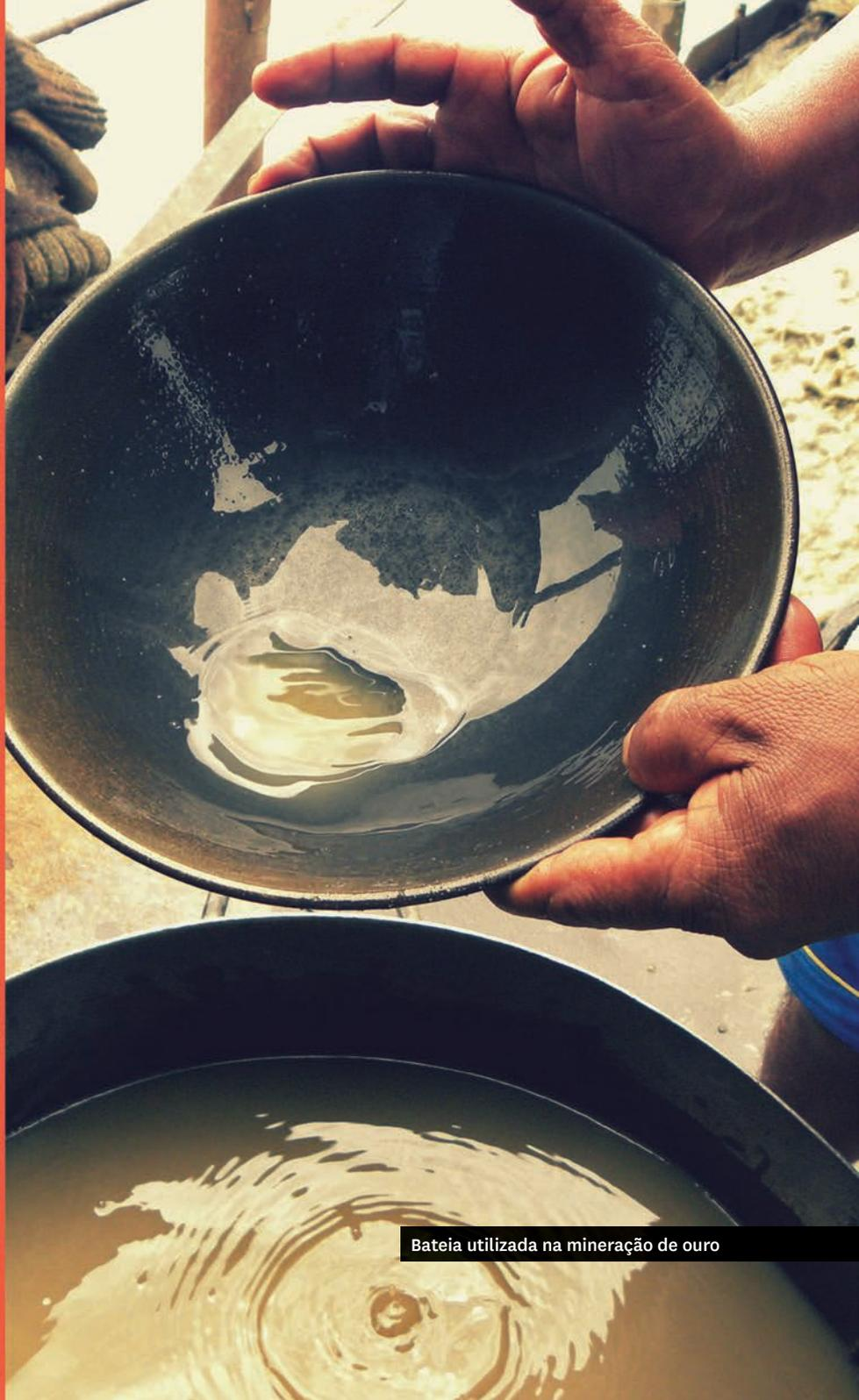
Bateia utilizada na mineração de ouro
